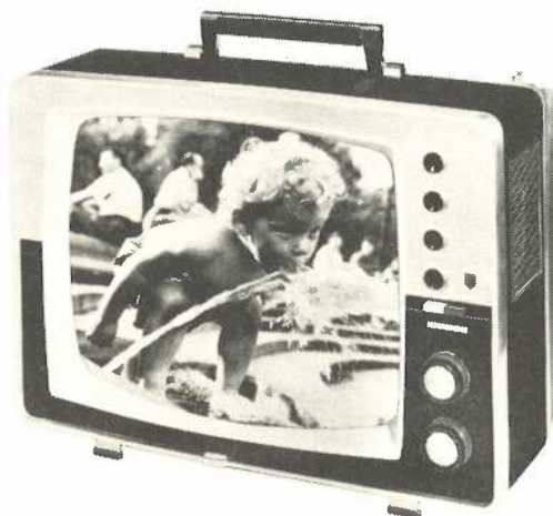
Het draagbare super-televisietoestel 19 TX 430 AT, geschikt voor aansluiting aan het lichtnet en op een accu van 12 volt.
